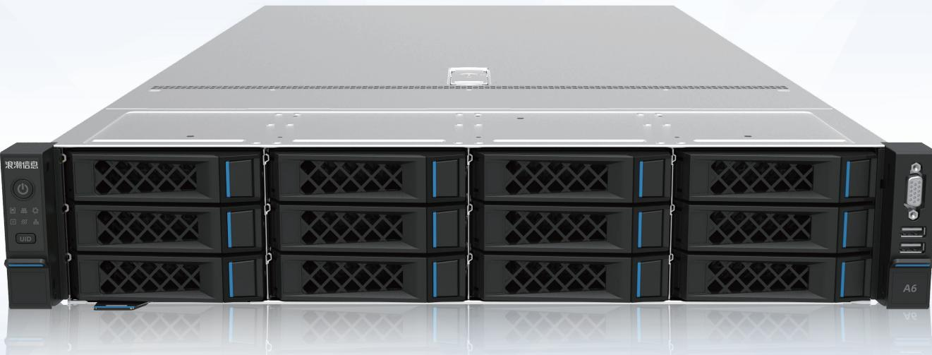
浪潮英信服务器NF3280A6，基于全新第三代超威EPYCTM Milan平台处理器设计的一款2U单路机架式服务器，该产品满足多核心、高主频、高扩展性等要求，使单处理器性能得到最大发挥，性能媲美传统双路产品，是浪潮为针对互联网、云计算、虚拟化、大数据等需求推出的一款机架式服务器，特别适合在大数据、CDN、视频转码、内存数据库等应用场景下提供服务。
