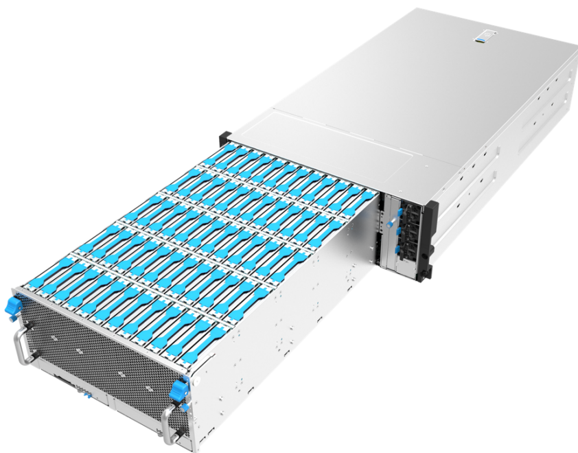
图 5-21 3.5 英寸硬盘模组整体外观
